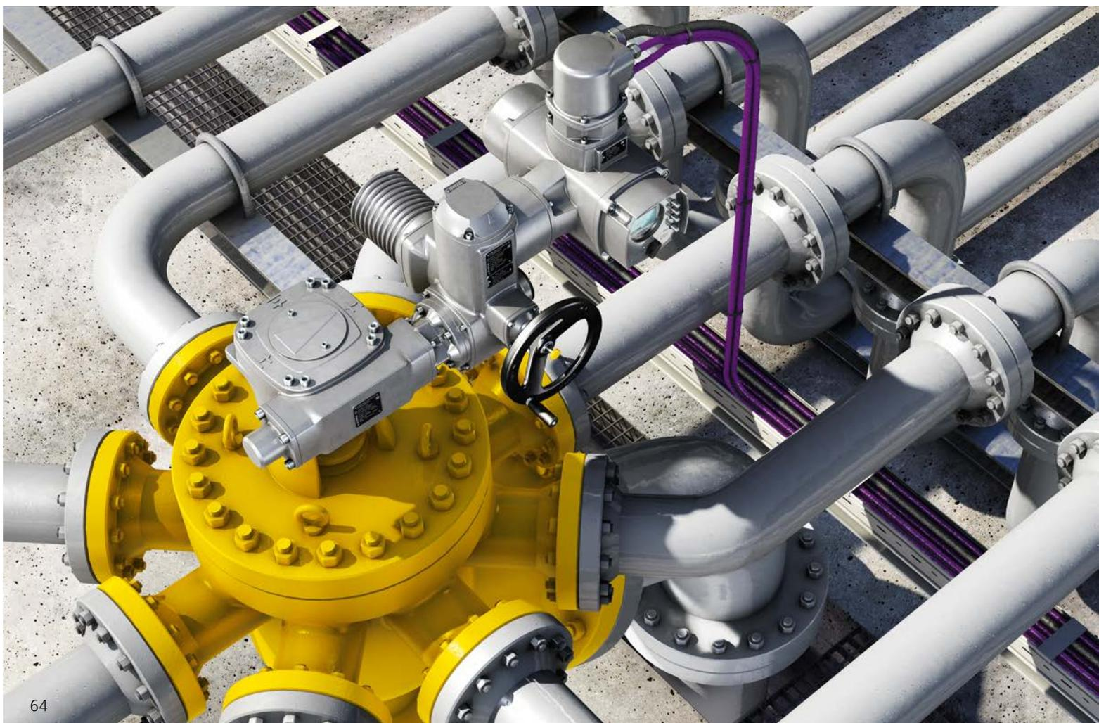
Temperaturas altas, presiones altas y/o medios con sólidos en suspensión son las razones por las que se utilizan las válvulas de macho ascendente. Estas válvulas cierran el paso metálicamente en ambos sentidos de flujo y disponen en el área del obturador, normalmente cilíndrico, de conexiones de lavado y purga. Estas válvulas encuentran aplicación, p. ej., en válvulas de cierre bidireccional y purga o en procesos de coquización retardada.
