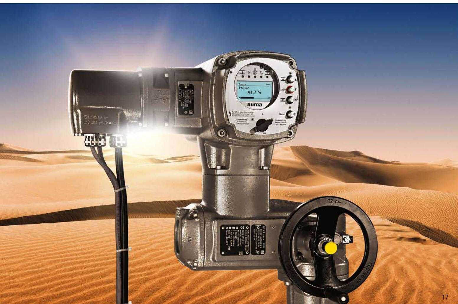
Otro factor decisivo para una larga vida útil de los dispositivos es la efectiva protección anti-corrosión de AUMA. El sistema anti-corrosión de los actuadores AUMA se basa en un tratamiento químico previo y un recubrimiento en polvo de dos capas de cada pieza. Para las diferentes condiciones de servicio hay clases de protección anti-corrosión graduadas de AUMA basadas en las categorías de corrosividad según EN ISO 12944-2.
