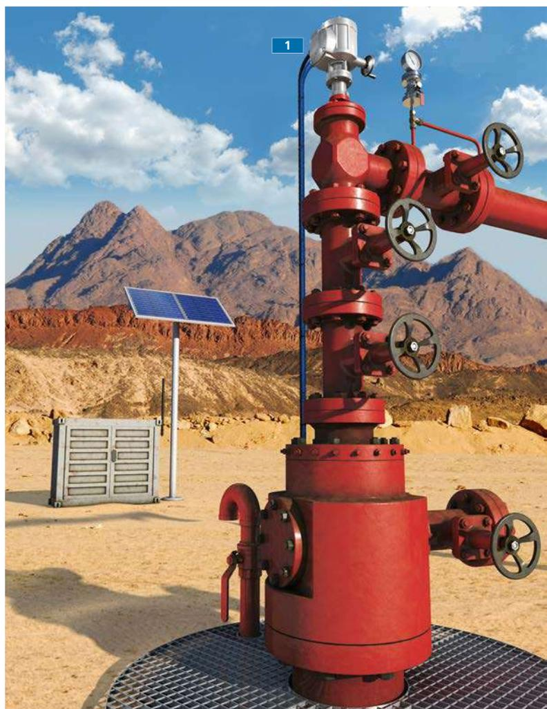
En caso de interrupción del suministro eléctrico, el actuador debe posicionar la válvula en una posición final determinada previamente sin ningún tipo de suministro de energía auxiliar. Así se define la función Fail-Safe en lo que respecta a los actuadores.
