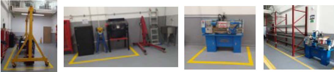
Señalización áreas de trabajo
